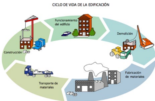
Figura 1. El ciclo de vida de un inmueble abarca desde la fabricación de los materiales para la construcción hasta su demolición.
